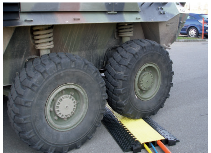
Test di carico con Piranha
